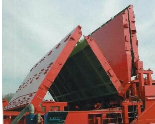
Bildet (fra Cargotec) viser et eksempel på hydraulisk opererte foldeluker.
